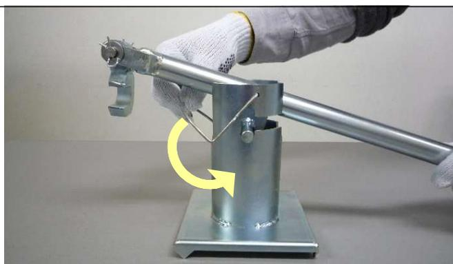
軸ストッパーを下げて支持軸に掛ける。
