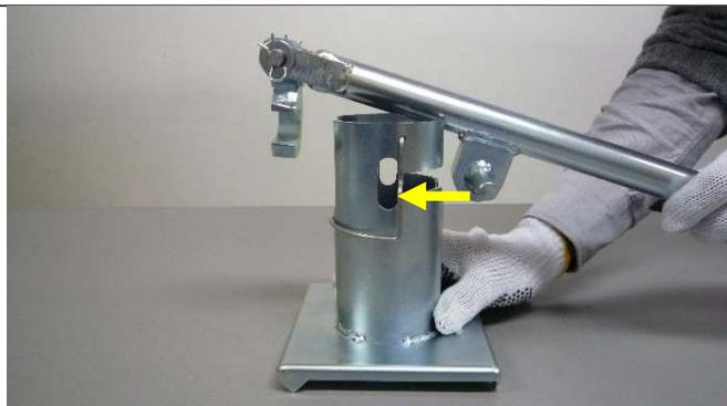
ハンドルバーの支持軸を下側にして支持台側面の切り欠きに支持軸を入れてセットする。
