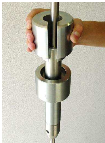
写真3 3kg ハンマーに 2kg ハンマーを装着
